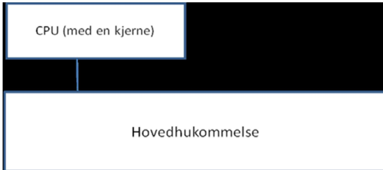
*Figur 19.1 Skisse av en datamaskin i ca. 1980 hvor det bare var én beregningsenhet, en CPU, som leste sine instruksjoner og både skrev og leste data (variable) direkte i hovedhukommelsen. Intel 8080: 1 MHz CPU*
