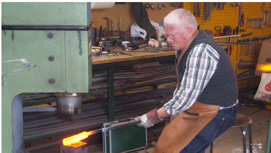
En konsentrert smed bruker en maskinhammer ved tillaging av knivblad. Foto, Svein 2005
