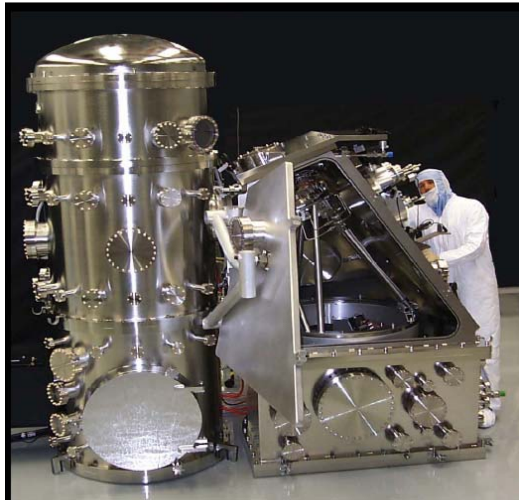
Optisk 'trykking' av kretser med ekstremt ultrafiolett lys
