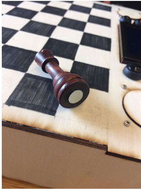
(a) Det er festet en magnet under brikkene
