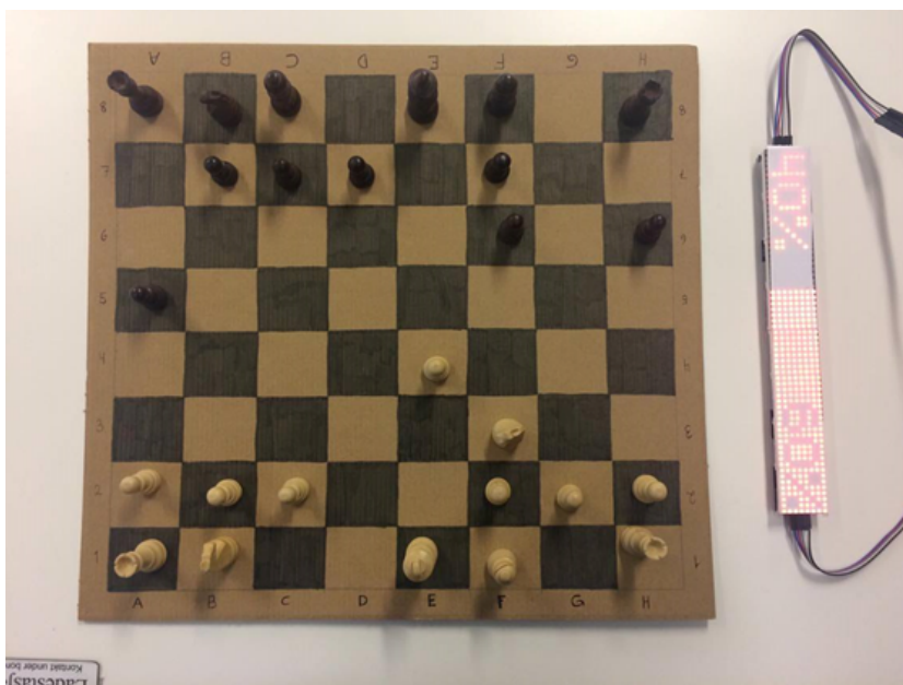
Figure 6: Bilde av prototype nr 1: Ada. Her ser vi brettet oven ifra med lysdioden til høyre. Lysdioden viser stillingen i sann tid gitt i prosent.
