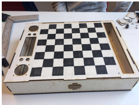
(a) Bilde av Charlotte. Prototype lagt av kryssfiner og laserkuttet ut områder til komponentene. På sidene vendt mot hver spiller, har vi lagt til høytalerhull.
