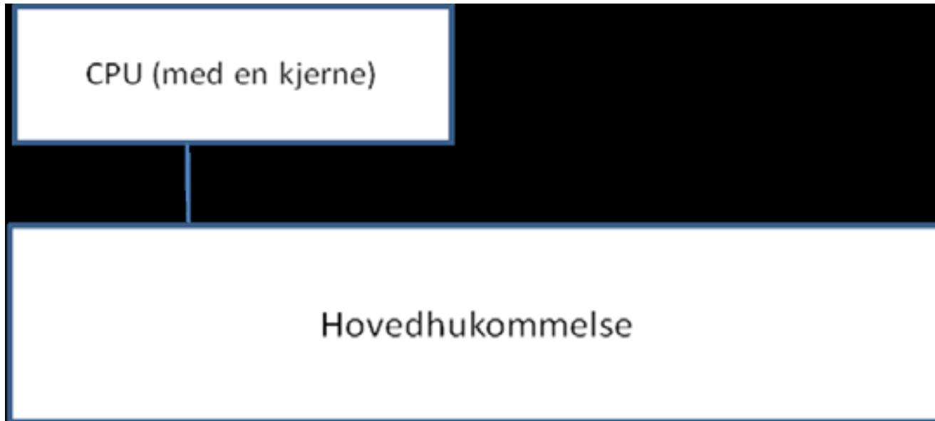
Skisse av en datamaskin i ca. 1980 hvor det bare var én beregningsenhet, en CPU, som leste sine instruksjoner og både skrev og leste data (variable) direkte i hovedhukommelsen.
