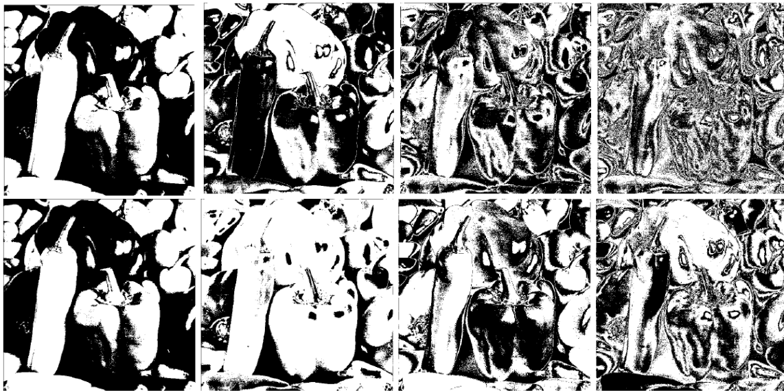
Figur 18-6. Fra venstre mot høyre: De fire mest signifikante bitplanene med naturlig binærkode (øverst) og med Gray-kode (nederst).
