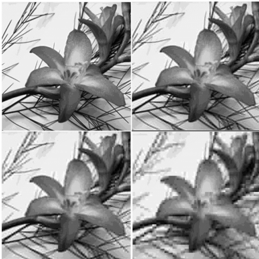
Figur 18-16. Effekten av å redusere antall DCT-koeffisienter.
