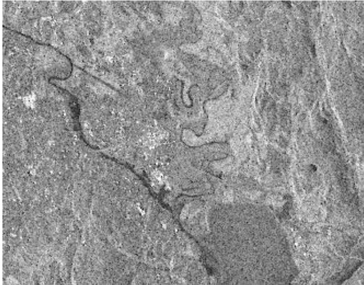
Bilde fra ERS-1 SAR-satellitten Radaren viser røffheten på overflater
