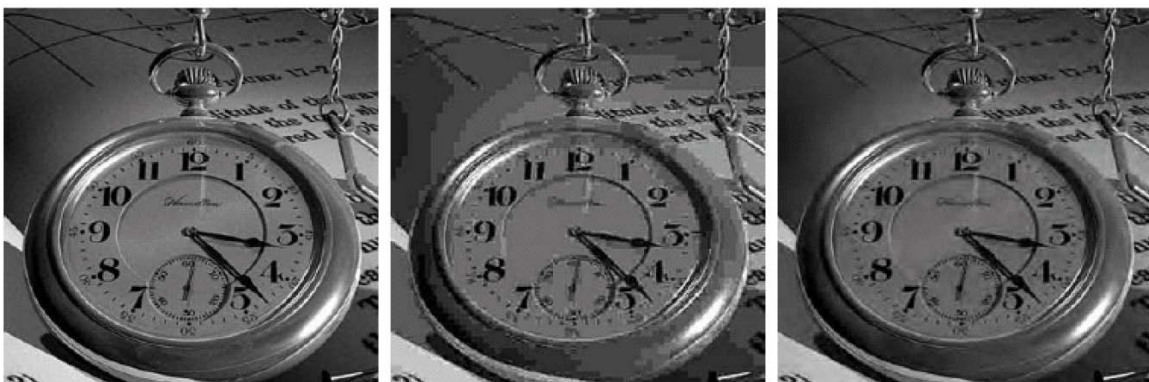
Figur 18-18. Et 512 \times 512 piksels 8 bits gråtonebilde (venstre) rekonstruert etter en 16:1 kompresjon (0.5 bit/piksel) med JPEG (midten) og JPEG 2000 (høyre).
