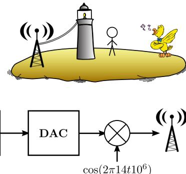
der LP står for lågpass, ADC er ein analog-til-digital omformar, DAC er ein digital-til-analog omformar,  $f_c$  er kuttfrekvens og  $f_s$  er samplingsfrekvens.
