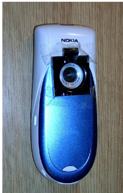
Linsen demontert og "montert" på en Nokia 3650. Funksjonelt, om enn ikke direkte vakkert.
