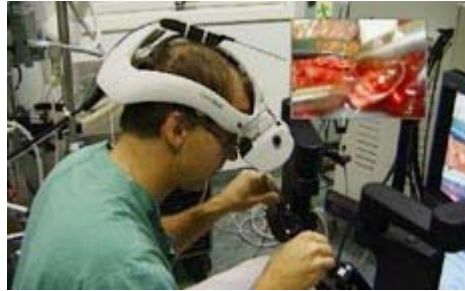
Figur 3 Operasjon med roboten Zeus. Kirurgen sitter ved siden av operasjonsbordet og styrer tre robotarmer. Armen som holder endoskopet er stemmestyrte, de andre styres av operatørens hender. Han styrer ved hjelp av et tredimensjonalt brillesett
