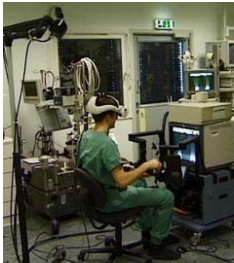
Figur 7 Operasjon med hodesporingssystemet. Tre kameraer over kirurgen monitorerer hodebevegelsene og overfører dem til Aesop-roboten
