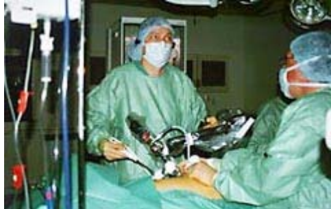
Figur 4 Operasjon med den stemmestyrte roboten Aesop som assistent. Kirurgen styrer torakoskopet med stemmen. Roboten "erstatte" en assistent
