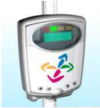
Illustrasjon 4 Bilde av en validator av samme type som skal installeres på busser, trikker, båter og t-banestasjoner
