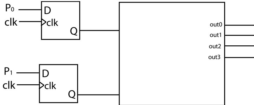
Det har blitt lagt til et register (2 D-flip-floper) på inngangssignalet (select) til dekoderen
