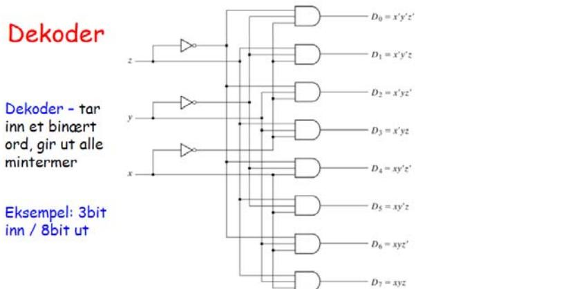
Kretsen kan ikke kalles en demultiplexer fordi den ikke har enable inn. Demultiplexer trenger en datalinje inn i tillegg til "select" (=p i dette tilfellet).
