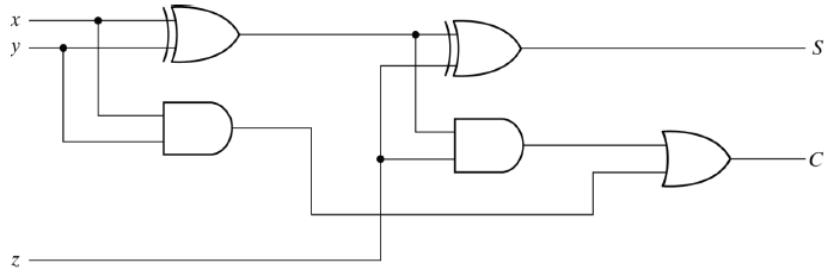
(Kretsen er en fulladder.) Her bør man spesifisere en "oversettelse" mellom inn-/utgangene  $x, y, z, S, C$  på kretsen og signalene  $S, A, B$  i addersystemet. Eksempel:
