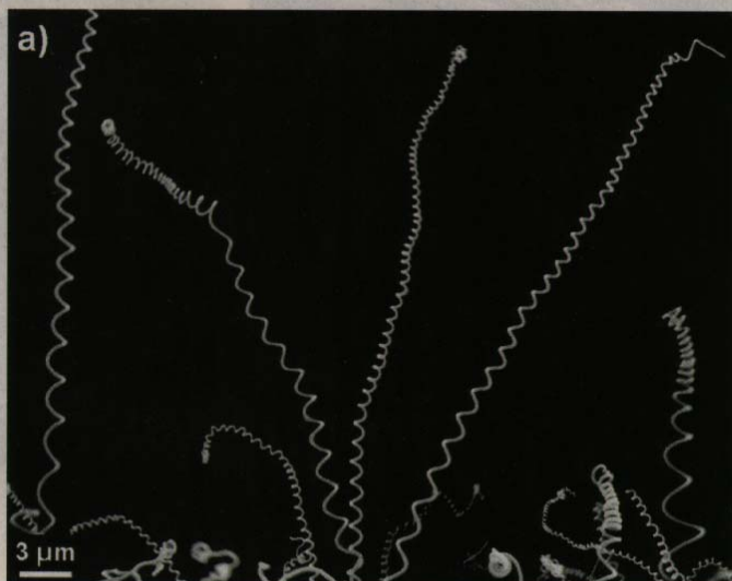
Abb. 6. a) Rasterelektronenmikroskopische (REM)-Aufnahme mehrerer pyrolytisch synthetisierter spiralförmiger Nanoröhrchen. b) Theoretisches Modell der korkenzieherartigen Gebilde.
