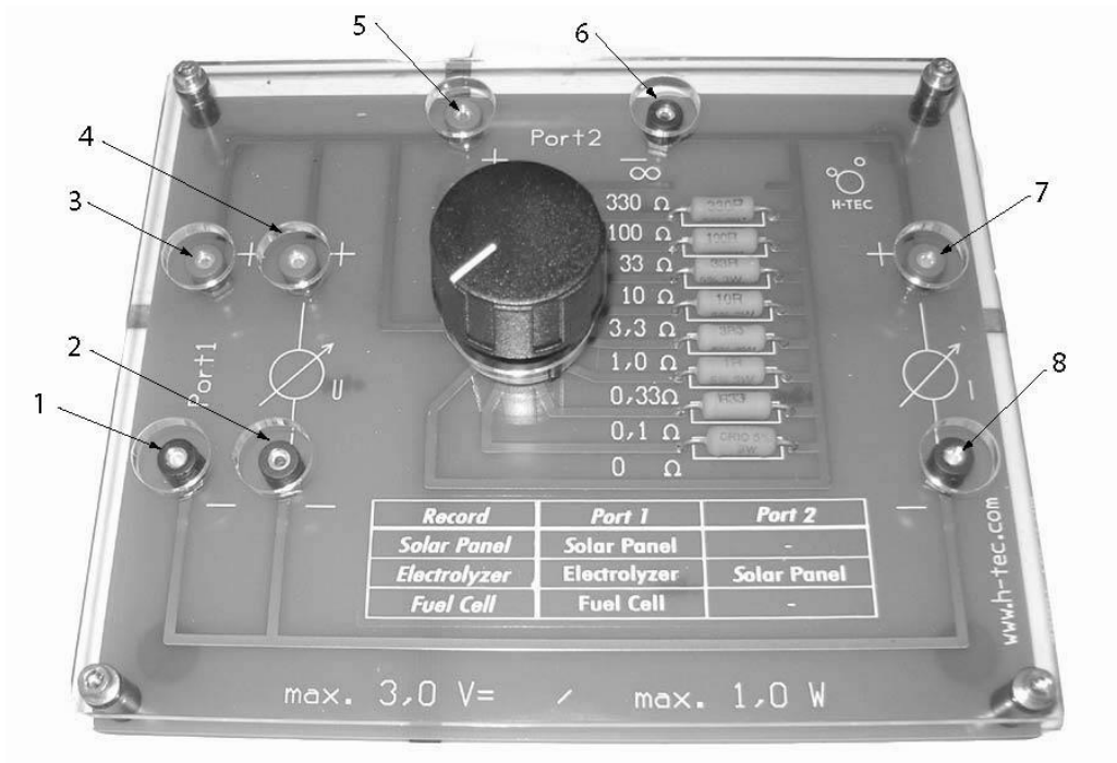
Figur 2: Dekademotstand med tilkoblinger for spenningskilde og måleinstrumenter.
