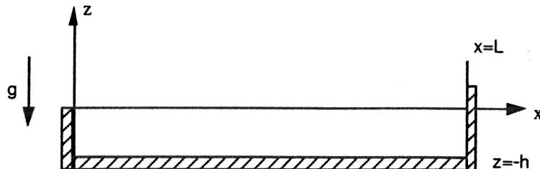
Lengden av bassenget er  $L$  og væskedypet er  $h$  når væsken er i ro og væskeoverflaten faller da sammen med  $x$ -aksen. Vi antar at svingningene (bølgene) i væsken har så liten amplitud at alle likninger kan lineariseres. Tyngdens akcelerasjon er  $g$ .
