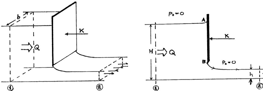
Væske som regnes homogen, inkompressibel og friksjonsfri strømmer stasjonært i en åpen kanal under en vertikal luke (plate) som vist i figuren. Bredden av kanalen er  $b$ , væskens tetthet  $\rho$ , det atmosfæriske trykket  $p_0$  settes lik null, tyngdens aksellerasjon er  $g$  og volumstrømmen i strømningen er  $Q$ . Hastigheten regnes uniform over tverrsnittene 1 og 2. Luka holdes på plass med en kraft  $K$ .
