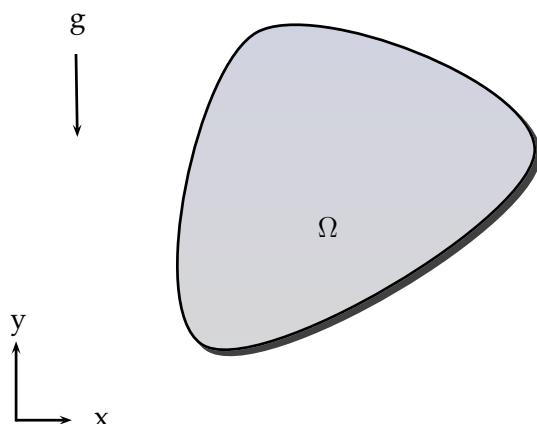
Vi ser på inkompressibel strømning av en Newtonsk væske ved konstant temperatur gjennom et rør med vilkårlig tverrsnitt, som vist i figuren. Røret antas å være uendelig langt og uforandret i z-retningen (normalt på arket). Strømningen i røret er drevet i positiv z-retning av en konstant trykkgradient og vi kan se bort ifra initialbetingelser. Tyngdekraften  $g$  virker i negativ y-retning som vist i figuren.
