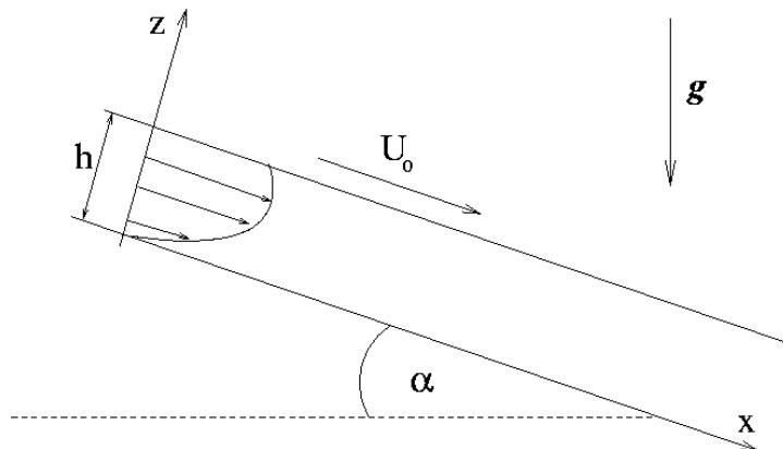
En homogen inkompressibel Newtonsk væske med tetthet  $\rho$  og viskositet  $\mu$  strømmer mellom to parallelle plater som ligger på skrå med helningsvinkel  $\alpha$ . Strømmen er stasjonær og plan i  $xz$ -planet. Topp-plata har avstand  $h$  fra bunn-plata og beveger seg med hastighet  $U_0$  i  $x$ -retningen. Bunn-plata står i ro.
