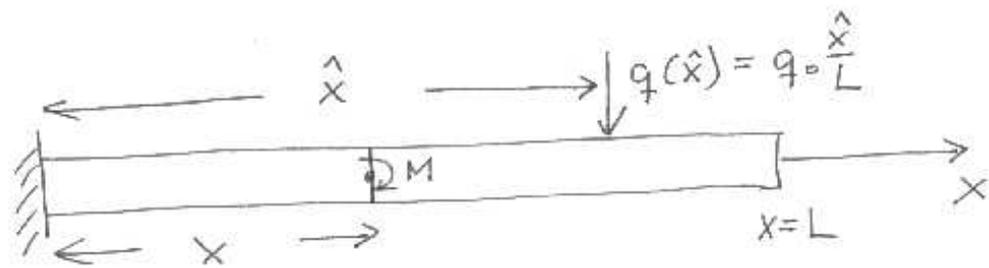
Momentet i snittflate i avstand  $x$  fra den fastspundte enden av lasten paa den delen av stanga som ligger utenfor denne snittflaten:
