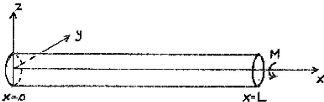
Staven er spent fast i enden  $x = 0$  og den utsettes for et vridningsmoment  $M$  i enden  $x = L$ . Vi forutsetter at vridningsvinkelen er liten og at tverrsnittsplan forblir normal til senteraksen under vridningen. Det er ingen ytre krefter bortsett fra vridningsmomentet på randen i enden  $x = L$ . Vi forutsetter stasjonær (likevekt) tilstand.
