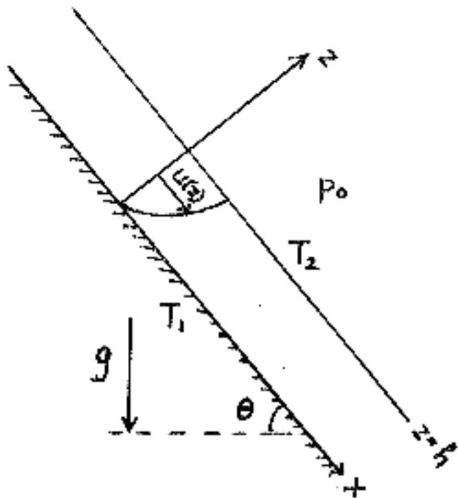
Vi antar at viskositeten er så stor at væskestrømmen er stasjonær og rettlinjet og at strømkomponenten i  $x$ -retning  $u(z)$  bare er en funksjon av  $z$ . Det virker ingen andre ytre krefter enn tyngden og vi antar at det ikke er trykkgradienter i  $x$ -retning i væsken eller skjærspenninger på væskeoverflaten ved  $z = h$ .
