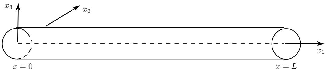
Sylinderen er fastspent i en vegg ved  $x = 0$ . I den andre enden pålegges et moment  $M\mathbf{i}_1$ , der  $\mathbf{i}_1$  er enhetsvektoren rettet langs  $x_1$ -aksen som ligger langs sylinderens senterlinje. Forskyvningsfeltet er gitt på formen
