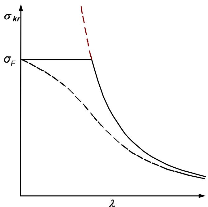
Redusert slankhet (brukt f.eks. i NS 3472 for stålkonstruksjoner):
