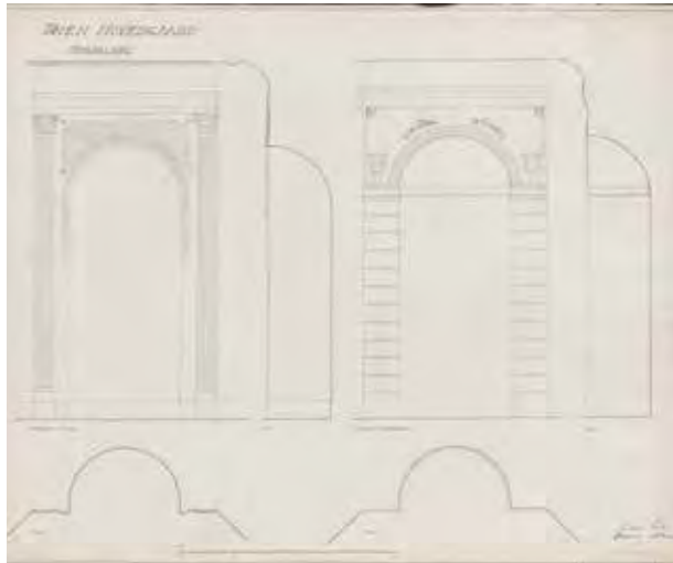
Oppmålingstegning av to av ovnsnisjene i hovedfløyen. De har ulik utforming og ornamentikk fra ulike perioder. Kilde: Riksantikvaren
