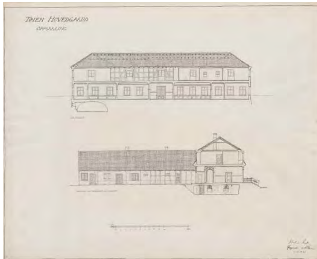
Oppmålingstegning fra 1922, viser langsnitt av hovedfasaden og østfløyens fasade mot vest med snitt av hovedfløyen.
