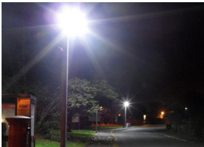
En blendende lyskilde gjør det vanskelig å se veien
